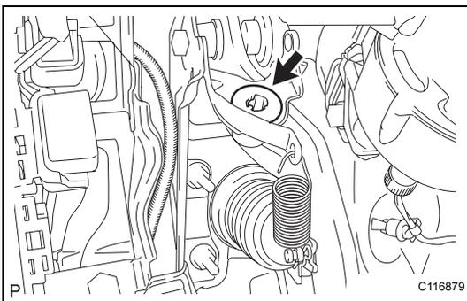
**20. SEPARATE BRAKE MASTER CYLINDER PUSH ROD CLEVIS**
