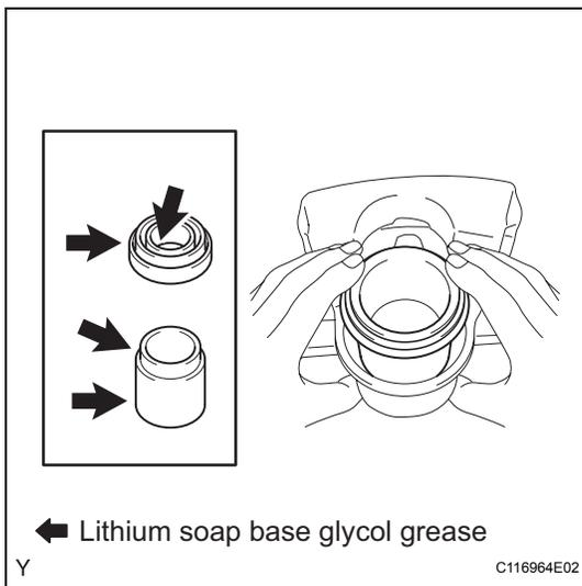
4. **INSTALL FRONT DISC BRAKE PISTON**
