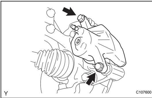
**10. INSTALL DISC BRAKE CYLINDER ASSEMBLY**
