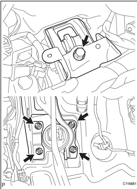
**21. REMOVE BRAKE PEDAL SUPPORT**
