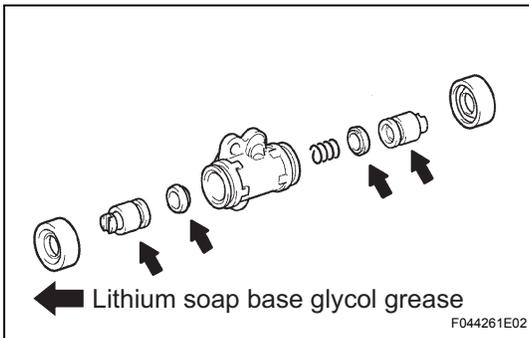
**2. INSTALL REAR WHEEL BRAKE CYLINDER ASSEMBLY**
