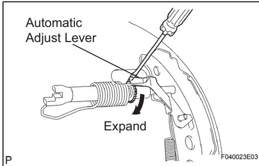
1. **INSTALL REAR BRAKE DRUM SUB-ASSEMBLY**
