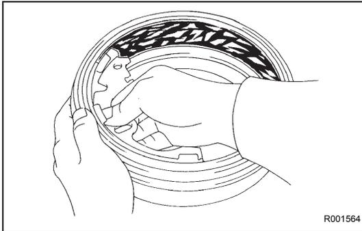
**3. INSPECT REAR BRAKE DRUM AND REAR BRAKE SHOE LINING FOR PROPER CONTACT**
