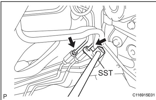
3. **INSTALL BRAKE MASTER CYLINDER PUSH ROD CLEVIS** (See page [BR-21](#))
