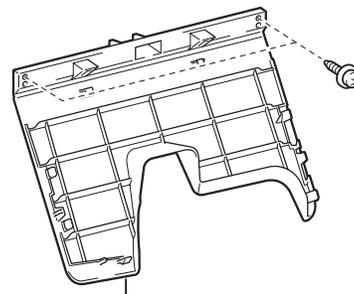
LOWER INSTRUMENT PANEL FINISH PANEL SUB-ASSEMBLY
