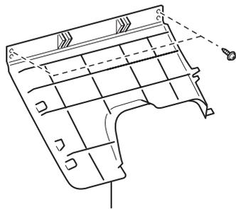
LOWER INSTRUMENT PANEL FINISH PANEL SUB-ASSEMBLY
