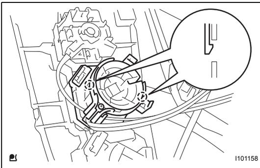
**8. DISCONNECT DEFROSTER DAMPER CONTROL CABLE SUB-ASSEMBLY**
