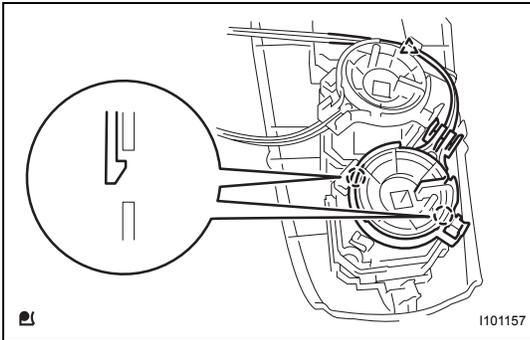
**7. DISCONNECT AIR MIX DAMPER CONTROL CABLE SUB-ASSEMBLY**
