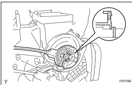
**9. INSTALL DEFROSTER DAMPER CONTROL CABLE SUB-ASSEMBLY**
