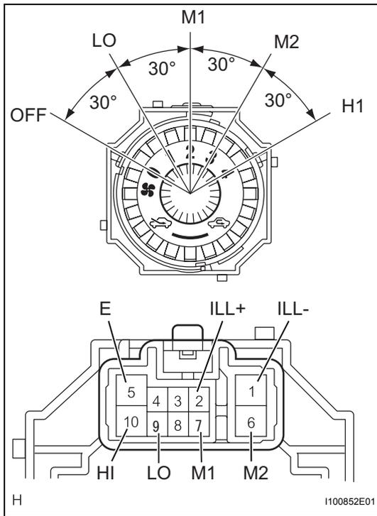
**2. INSPECT HEATER CONTROL SUB-ASSEMBLY**
