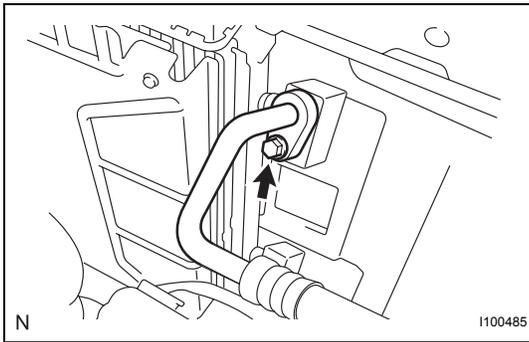
**3. INSTALL NO. 1 COOLER REFRIGERANT DISCHARGE HOSE**
