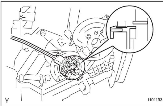
**7. INSTALL AIR MIX DAMPER CONTROL CABLE SUB-ASSEMBLY**
