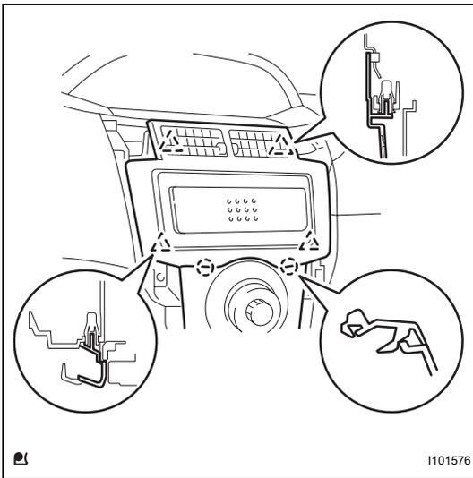
**5. INSTALL INSTRUMENT CLUSTER FINISH PANEL SUB-ASSEMBLY CENTER**
