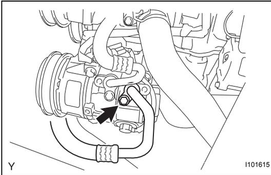
6. DISCONNECT NO. 1 COOLER REFRIGERANT DISCHARGE HOSE
