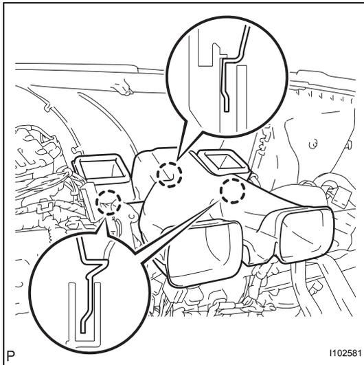
11. **INSTALL HEATER TO REGISTER DUCT ASSEMBLY**
