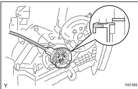
**8. INSTALL AIR MIX DAMPER CONTROL CABLE SUB-ASSEMBLY**
