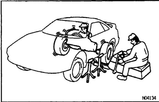
**3. PLACE THE WHEEL BALANCER AGAINST THE WHEEL TO BE BALANCED**
