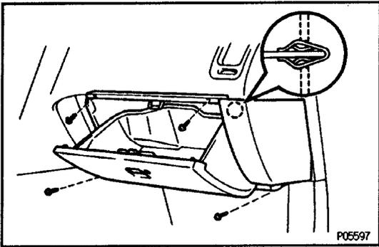
**3. REMOVE LOWER NO.2 INSTRUMENT FINISH PANEL**
