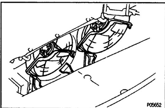
(d) Check that the cooling fans rotates.
