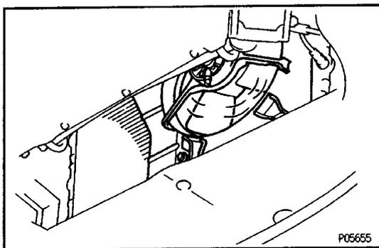
(d) Check that the cooling fan rotates.
