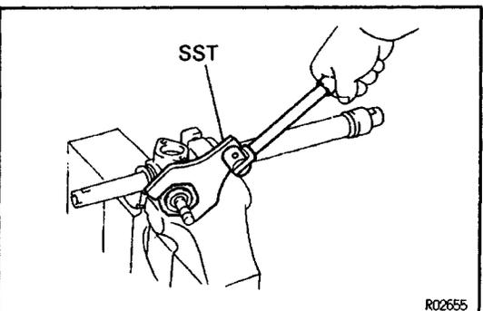
**13. REMOVE PINION BEARING ADJUSTING SCREW LOCK NUT**
