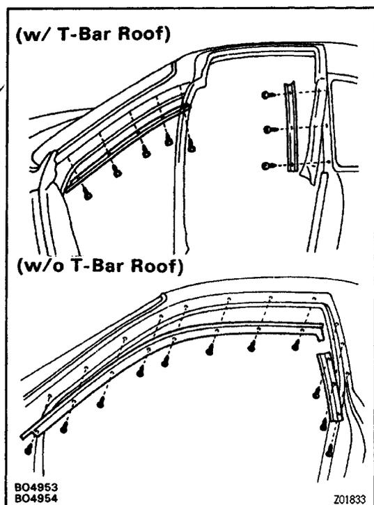
2. **REMOVE ROOF DRIP SIDE FINISH FRONT MOULDING**
