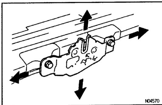
**4. ADJUST ENGINE HOOD LOCK IN FORWARD/REARWARD AND LEFT/RIGHT DIRECTIONS**
