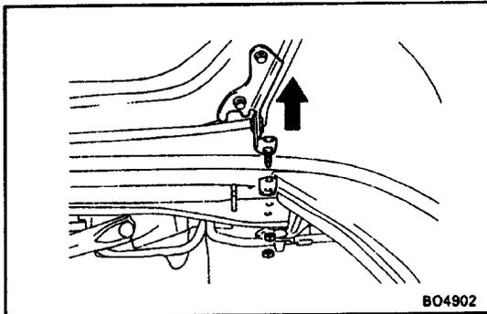
**2. ADJUST FRONT EDGE OF ENGINE HOOD IN VERTICAL DIRECTION**
