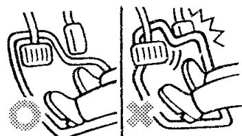
カーペットの穴は、トヨタ純正フロアマットのずれを防止するために使用する固定クリップ取りつけ用です。
